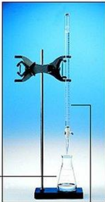
(a) Bureta de 50 mL con NaOH de concentración conocida.
